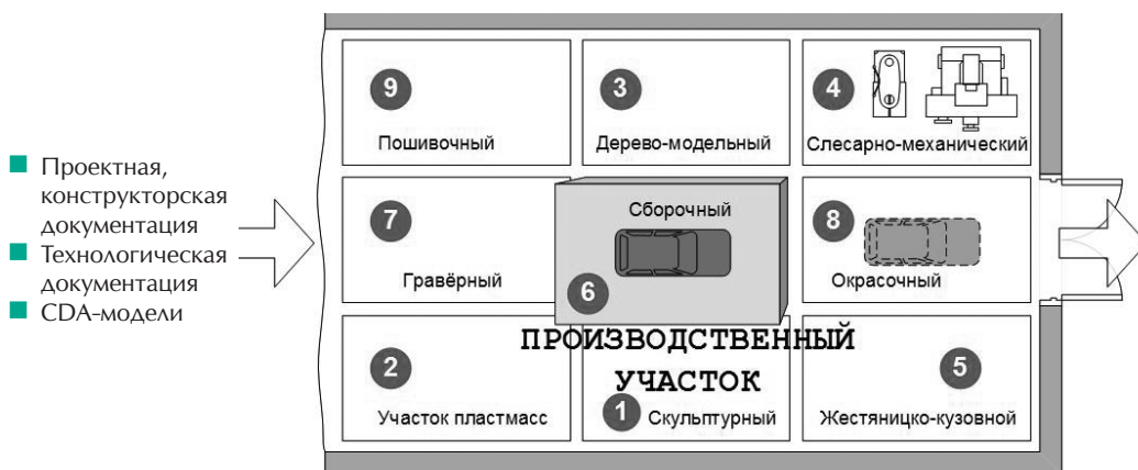
Рис. 3. Структура производственного участка по изготовлению гоночного болида
